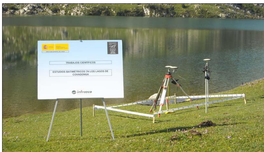
Figura 25. Estación base, GPS cinemático referenciándose y GPS tomando posición real de la estación base.
